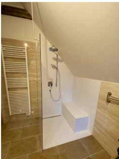
Der 1,2 cm starke Quartzkomposit Silestone Blanco Zeus wurde großflächig eingesetzt. Der ungenutzte Raum am Ende der Dachschräge wurde mit einer Sitzbank, die ebenfalls mit dem Quartzkomposit eingefasst wurde, nutzbar gemacht und dadurch aufgewertet.
