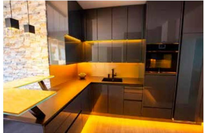
Dekton Sirius, 2 cm; flächenbündig eingebautes Kochfeld und poliertem Ausschnitt für Unterbauspüle sowie Rückwand in 8 mm Stärke aus demselben Material
