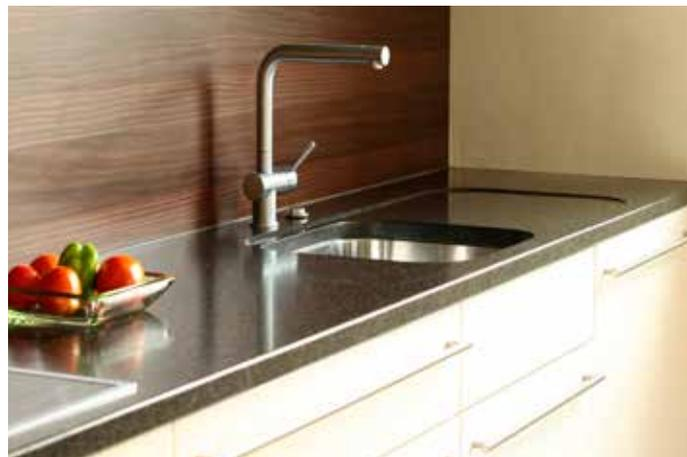
Küchenarbeitsplatte aus Granit Impala in 3 cm und polierter Oberfläche, Unterbauspüle und abgesetzter Tropftasse
