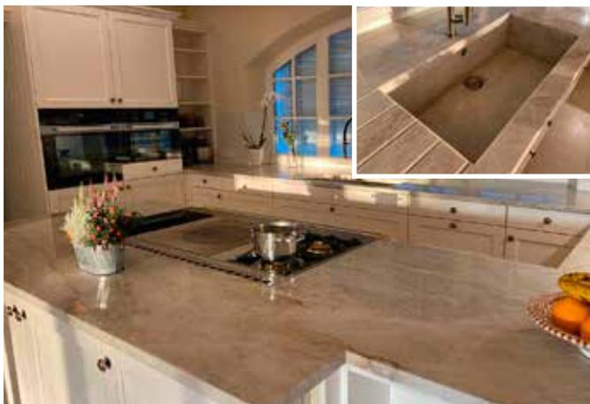
Küchenarbeitsplatte aus Quarzit Taj Mahal in 3 cm Stärke und polierter Oberfläche, flächenbündig eingebautem Gaskochfeld und Spüle auf Gehung in Wunschgröße sowie Abtropfrillen.
