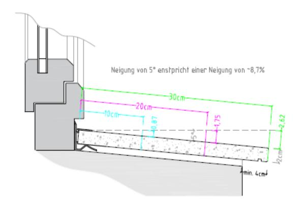
Die Neigung der Fensterbank ist nach vorne mit einem Mindestgefälle von 5 Grad auszuführen. Der Fensterbankvorsprung bzw. die vordere Abkantung sollte mindestens 40 mm vor dem fertiggestellten Fassadensystem liegen. Verwendete Dichtbänder müssen der Beanspruchungsklasse BG1 gemäß DIN 18542 entsprechen.
